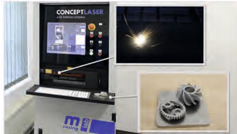
Im Inneren schichtet der 3D-Drucker mikrometerdünne Lagen hochlegiertes Stahlpulver übereinander, die mit Hilfe eines Lasers zu einer festen Struktur verschmelzen. Foto: HWK Dresden
