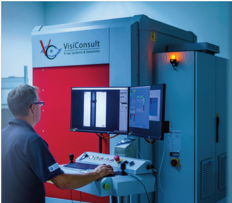
Im Prüflabor der Schweißtechnischen Lehranstalt werden zerstörungsfreie – wie hier die Röntgenprüfung – aber auch zerstörende Werkstoffprüfungen durchgeführt. Foto: André Wirsig
